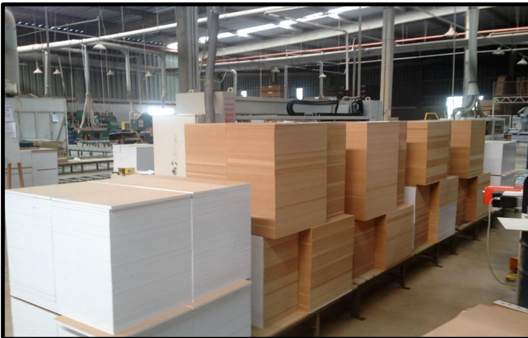
Figura 3 – laterais de armários usinadas pela máquina F 500-B Furadeira.
