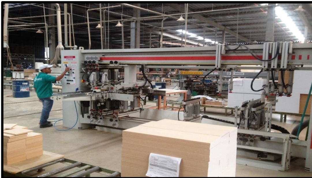
Figura 1 – máquina F 500-B Furadeira industrial (em funcionamento).
